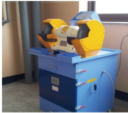
그라인딩 연마작업 시 발생 금속 분진 집진
